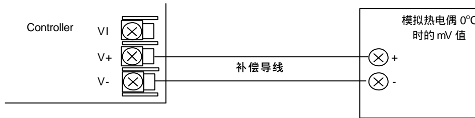
图 25-2: 热电偶校准的接线
